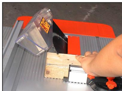
**Mode scie onglet double :** dans ce cas la pièce à couper est placée contre le guide et sciée sur sa largeur sous un angle combiné à onglet et à chanfrein.
