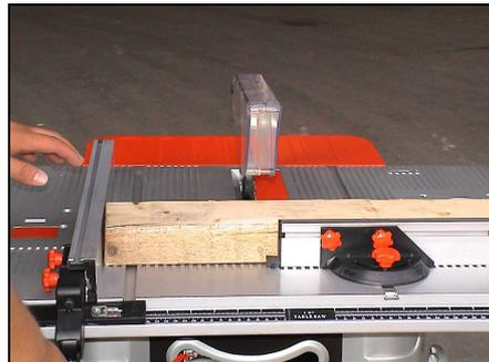
**Coupes en longueur :** En mode sciage en longueur, la pièce à ouvrir est avancée le long du guide parallèle et sciée à angle droit sur sa longueur.
