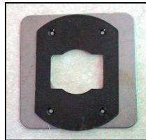
4. Percez la plaque pour y fixer la défonceuse (fixer avec les vis du patin de la défonceuse) et assemblez le tout sous votre table de scie (avec des vis à tête plate), le porte fraise s'incère dans la lumière de la table.
